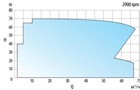
Справочный график для насосов серии UCL (2900 об/мин, 50 Гц),
