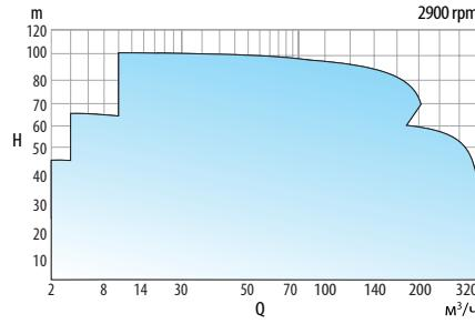
Справочный график для насосов серии UTS (2900 об/мин, 50 Гц),
