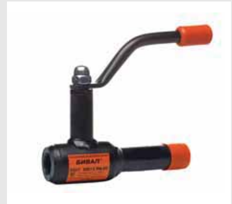
КШТ Серия 11/12, DN 15–50, PN 4,0 МПа Резьба/Сварка
